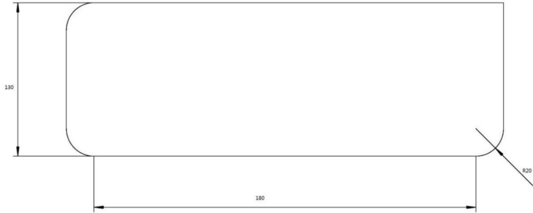
图 1-1 机器人运行轨迹平面尺寸图
